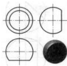
图 4-24 正平面切割圆球
