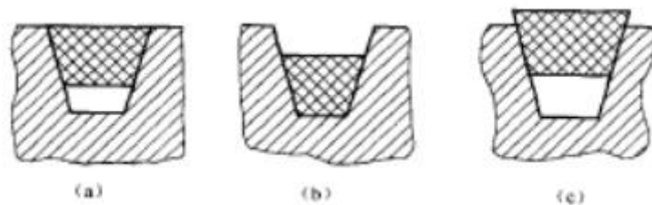
图 11-8 V 带的安装情况
