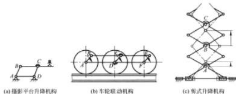
图 8-8 平行四边形机构应用实例
