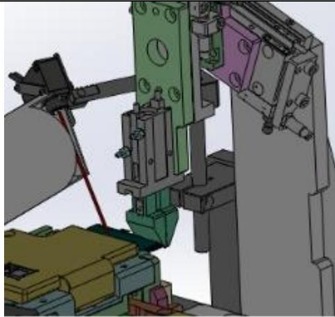
排不良工位：对 NG 产品，用机械手夹取移至不良排出皮带，排除。
