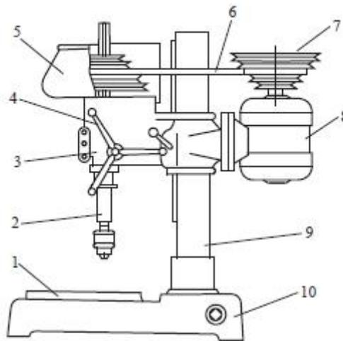
**Drill press used on bench 台式钻床**
