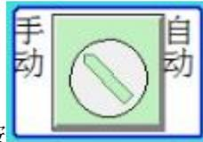
注：当设备运行中出现报警状况，请按
