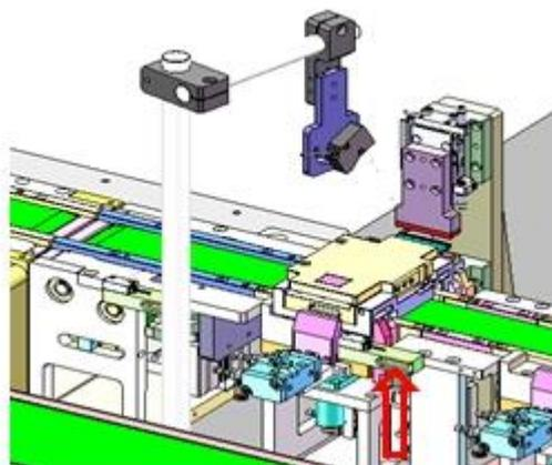
贴凹槽胶纸工位：对OCV测试OK产品，头部贴入凹槽胶纸。
