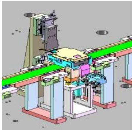
撕标工位：利用夹爪撕掉胶纸上面的离型纸。
