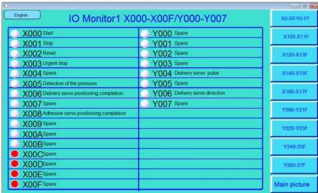
本设备画面实时监控 PLC 输入输出的变化，画面中输入输出点指示红色为代表有信号输入，白色代表无信号输入。
