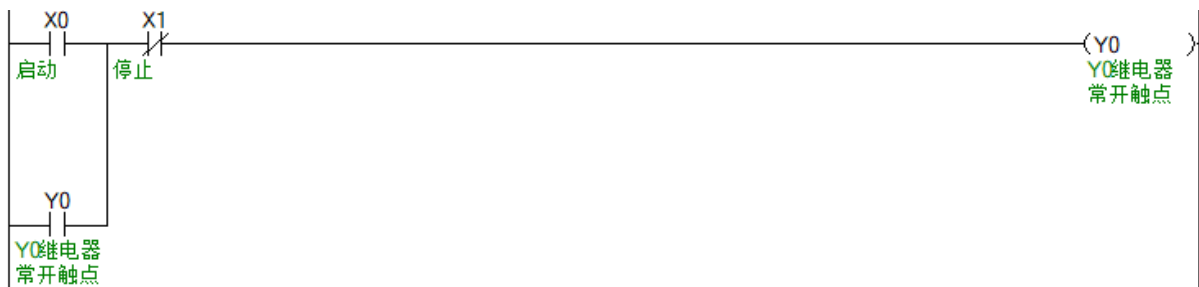
图 4-18 启停带自锁开关的梯形图
