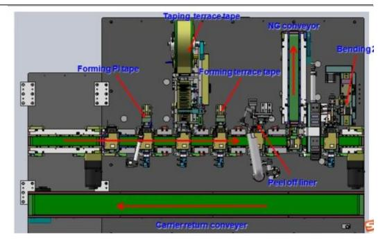
镍片整形工位:对贴防水胶电池进行镍片整形。
