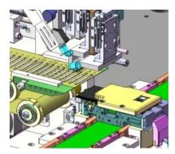
胶纸整形工位:使用整形块对贴完凹槽胶的产品进行整形,使胶纸能贴紧凹槽内。
