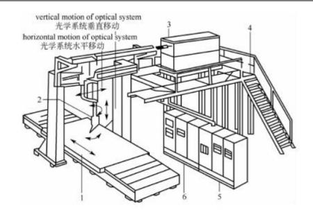
Laser beam machine 激光加工机 1-moving table 移动工作台 2-cutting head 切割头 3-laser head 激光头 4-platform 平台 5-power 电源 6-NC system 数控系统
