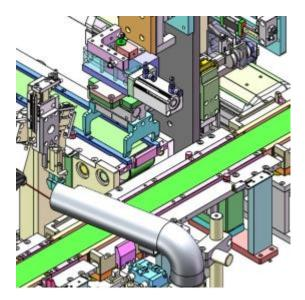
折弯二工位:贴完凹槽胶纸的产品,对 PCM 进行折弯。
