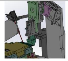
排不良工位:对 NG 产品,用机械手夹取移至不良排出皮带,排除。
