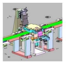
撕标工位:利用夹爪撕掉胶纸上面的离型纸。
