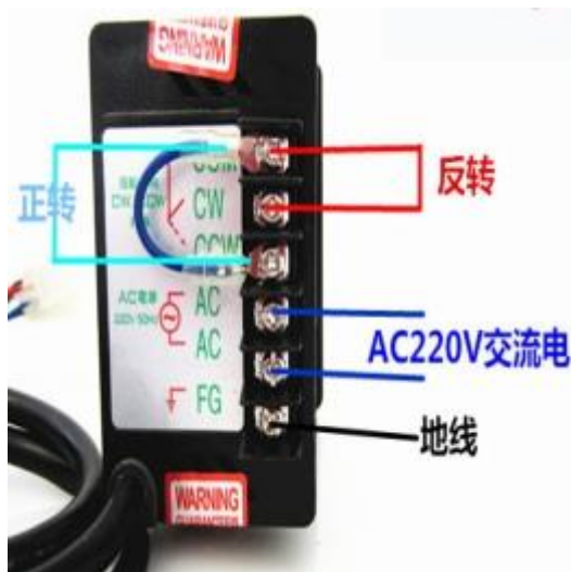
图 4-3 单相交流电动机速度调节器接线
