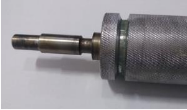
图 5-2 传动轴磨损图
